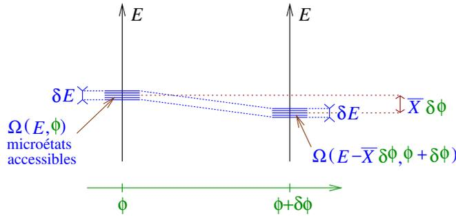
FIGURE 2 : Évolution des microétats accessibles lors d'un changement du paramètre  $\phi \rightarrow \phi + \delta\phi$ .
