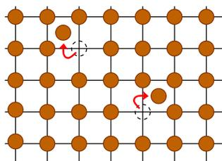
FIGURE 1 : Cristal de  $N = 35$  atomes avec deux défauts de Frenkel.
