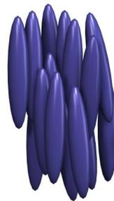
Schéma de l'ordre orientationnel dans la phase nématique d'un cristal liquide.
