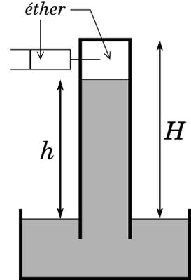
1/ Le mercure est considéré comme un liquide incompressible de masse volumique  $\rho$ . On note  $P_0$  la pression atmosphérique. Exprimer  $P_0$  en fonction de  $h_0$  puis la pression  $P$  de l'éther au sommet de la colonne en fonction de  $h$  et  $h_0$ .
