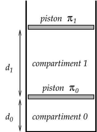
**1/** On bloque le piston  $\pi_0$ , le piston  $\pi_1$  restant libre de se déplacer. Le dispositif est alors dans l'état d'équilibre  $A$  caractérisé par  $T_0^A = 300 \text{ K}$ ,  $P_0^A = 10^5 \text{ Pa}$ ,  $d_0^A = 0,2 \text{ m}$ ,  $T_1^A = 300 \text{ K}$ ,  $P_1^A = P_{\text{atm}} = 10^5 \text{ Pa}$  et  $d_1^A = 0,15 \text{ m}$ .
