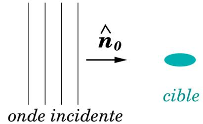
Le mécanisme de rayonnement est le suivant: l'onde incidente provoque des oscillations des charges et des courants dans la cible, à la pulsation  $\omega$ . La cible rayonne alors des champs de même pulsation. On écrira donc les champs rayonnés sous la forme
