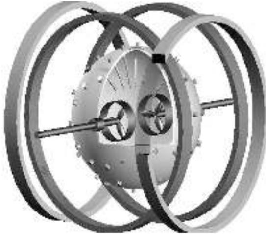
**FIG. 2.5:** Illustration schématique de l'expérience du Wisconsin. On voit clairement les deux hélices plongées à l'intérieur de la sphère.
