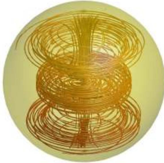
**FIG. 4.10:** Lignes de champ magnétique du dipole axial observé dans les simulations, pour  $Re = -76$  et  $Rm = 170$ , après une vingtaine de temps résistifs. On notera la forte axisymétrie du champ magnétique.
